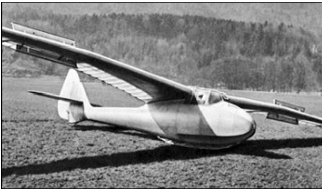
Spyr IV, 1939, Konstrukteur: August Hug, Spannweite 16,40 m, Gleitzahl 30
