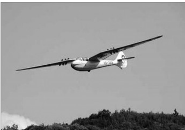
Spyr V; 1942/43, Konstrukteur: August Hug; Spannweite 18,4 m, Gleitzahl 24
